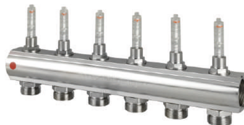
MS razdelnik FF sa protokomerima art. 1013, "Icma", odvodni vod Razmak između priključaka 50 mm Priključak: Spoljni navoj eurokonus 3/4" Izbor aktuatora sa navojem 28x1,5
