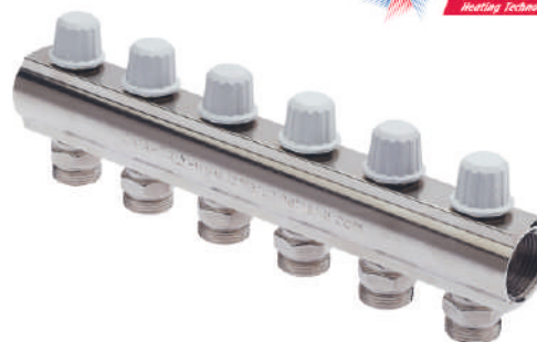
MS razdelnik FF sa navijcima art. 1005, "Icma", odvodni vod Razmak između priključaka 50 mm Priključak: Spoljni navoj eurokonus 3/4" Izbor aktuatora sa navojem 28x1,5
