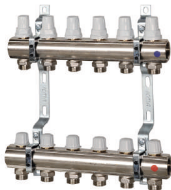
MS razdelni set sa ventilima art. K005, "Icma", sa termostatskom opcijom, posešavajućim navijcima i antivibracionim nosačem Razmak između priključaka 50 mm Priključak: Spoljni navoj eurokonus 3/4" Izbor aktuatora sa navojem 28x1,5
