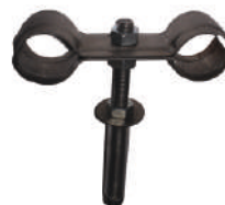
Dvodielna crna šelna Dimenzija 3/8" - 2" Navoj držača M8x130 Otvor u zidu Ø12
