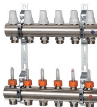
MS razdelni set sa protokomerima art. K013, "Icma", sa ventilima sa termostatskom opcijom, i antivibracionim nosačima Omogućava zatvaranje i regulaciju protoka. Razmak između priključaka 50 mm Priključak: Spoljni navoj eurokonus 3/4" Izbor aktuatora sa navojem 28x1,5
